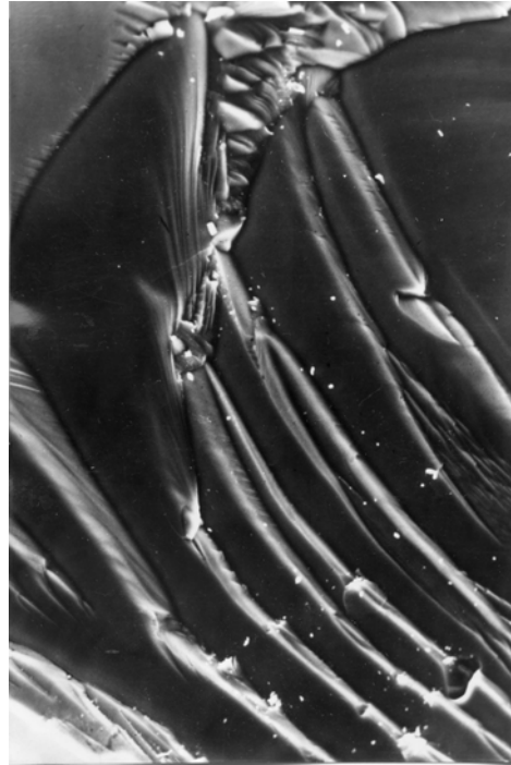
Рис. 4. Електронне зображення шаруватої структури пластини (після обробки у виборчому травнику Секко протягом 2 хвилин).
