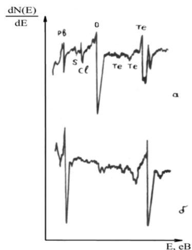
Рис. 1. Оже-спектри плівок РbТе: а - вихідні, б - протравленні на протязі 2 хв.
