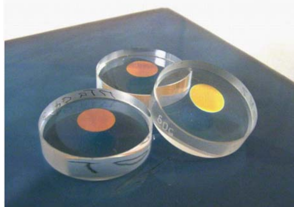
Рис. 1. Експериментальні зразки дзеркал He – Ne лазера з багатошаровими покриттями на основі ПУМ \text{Sm}_2\text{Ti}_2\text{O}_7 та \text{SiO}_2 .
