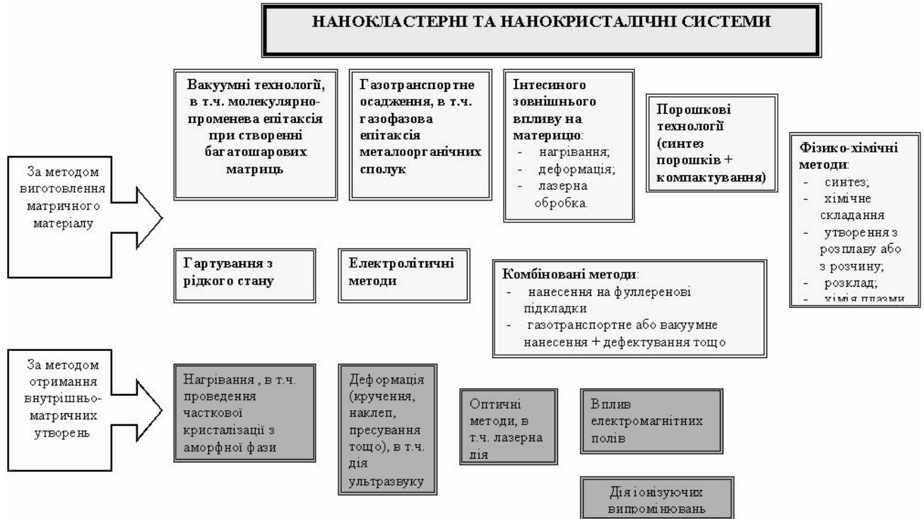
Рис. 1. Класифікація нанокластерних та нанокристалічних систем за технологічними особливостями отримання, проведена за [1-10].
