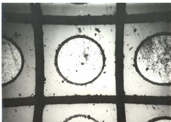
Рис. 1. Електронне зображення досліджуваних контактів нікель-кремній з бар'єром Шоткі.
