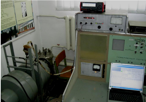
Рис. 4. Загальний вигляд установки автоматизованих вимірювань електричних параметрів напівпровідникових плівок.
