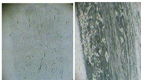
Рис. 4. Топографія поверхні тертя на склі сталю 3: а) з напрямом магнітного поля N->S т. № 1, б) при напрямі S->N магнітного поля в т. № 3.
